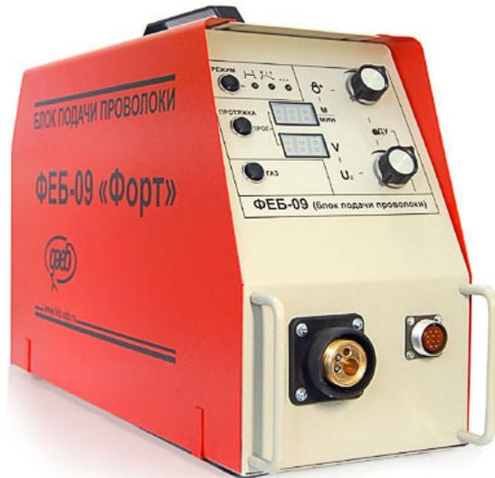
Блок подачи проволоки с цифровой индикацией для дуговой сварки в среде защитного газа ФЕБ-09 "ФОРТ", предназначен для сварки сплошной электродной проволокой диаметром 0,8-1,6 мм (в том числе стальной, нержавеющей и алюминиевой) в среде активных и инертных газов в составе полуавтомата со сварочным источником МАГМА-315У.
